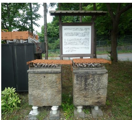
写真6 塩素酸カリウムの電解製造に使用した白御影石製電解槽および電極 (昭和電工(株)東長原事業所)
